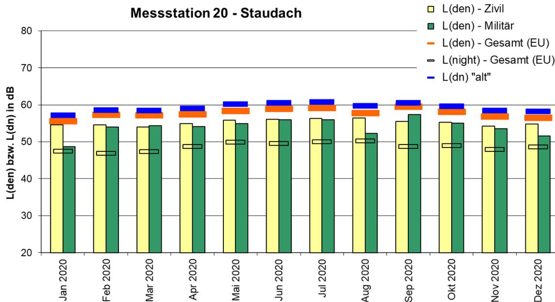
Anmerkung: Erklärung zu  $L_{den}$ ,  $L_{dn}$  und  $L_{night}$  siehe unter "Begriffe und Definitionen". Die Darstellung dokumentiert den Unterschied zwischen "alter" Rechenmethode und aktueller EU-Berechnung sowie den Dauerschallpegel in der Nacht. Die Differenz resultiert aus den unterschiedlichen Beurteilungszeiträumen und dem Zuschlag für die Abendzeit nach der EU-Berechnung.
