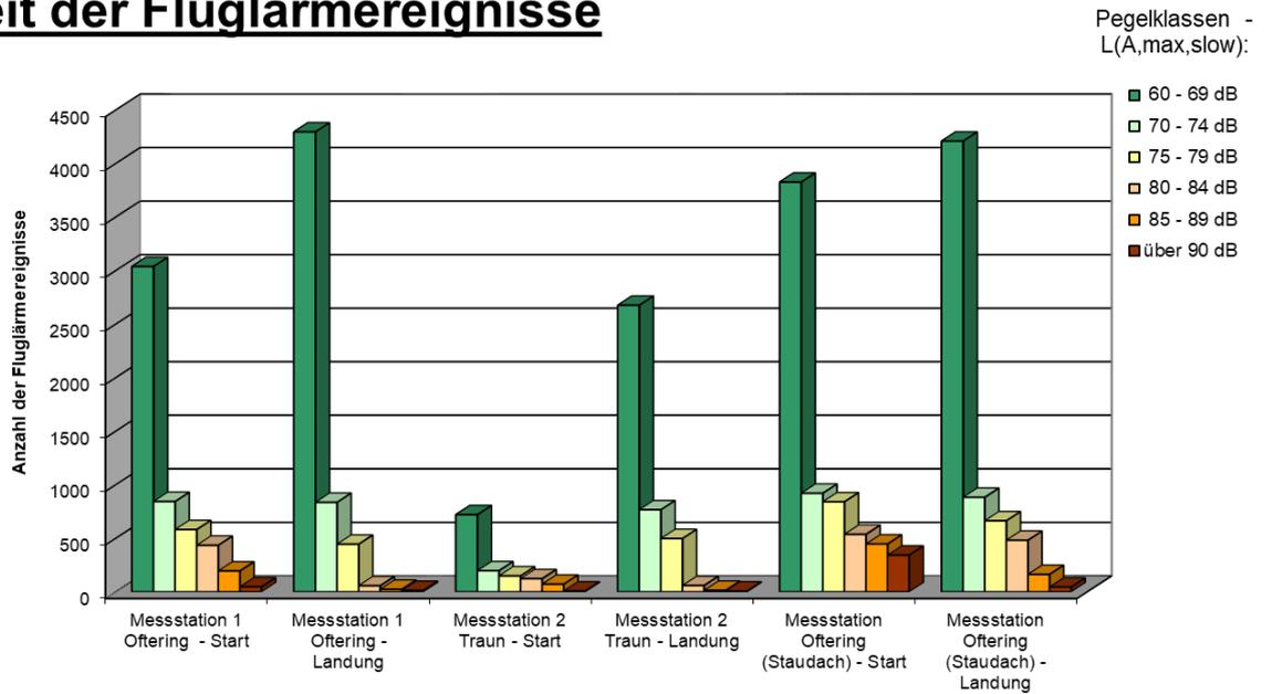
Anmerkung: Die Anzahl der Fluglärmereignisse in den einzelnen Pegelklassen ist nach Start und Landung getrennt. Die Klassierung erfolgt nach den gemessenen Maximalpegel der Flugereignisse bei den einzelnen Messstationen.
